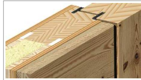
Detail: Standard-Türblatt Rohling mit Massiv-Altholz Applikation
