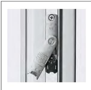
Flügelheber bringt den Flügel in die jeweils optimale Schließposition. Die Fehlbedienungssperre verhindert bei geöffnetem Flügel ein unbeabsichtigtes Fehlbedienen des Beschlags.
