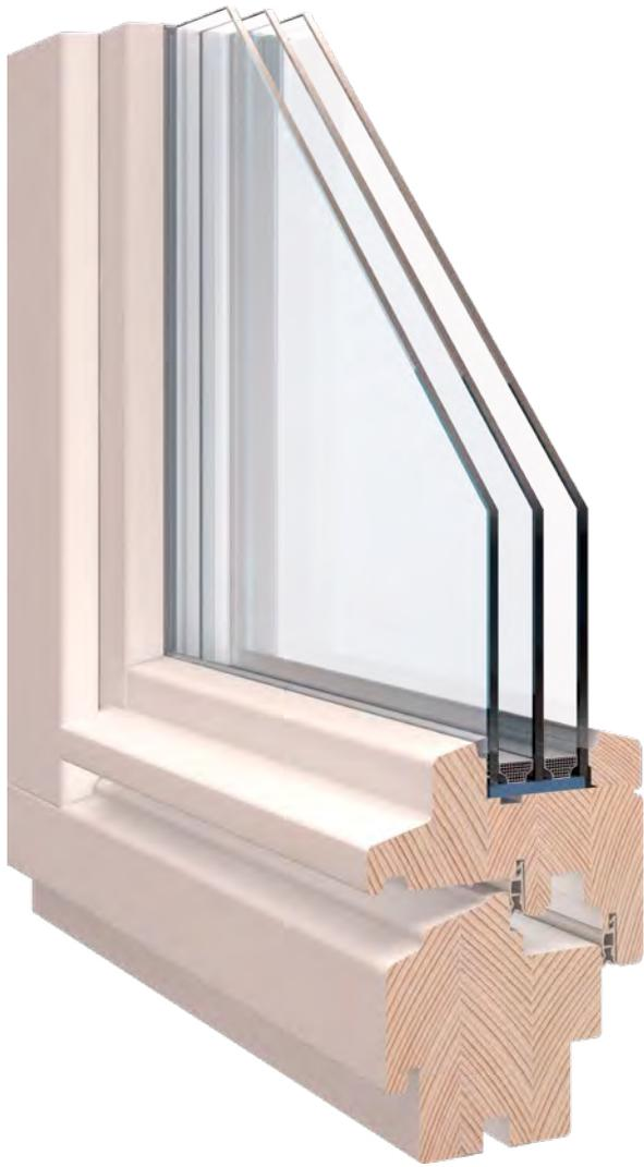
Das untere Flügelholz mit integriertem Wetterschenkel wird aus einem Stück Holz gefertigt, somit ist kein Wassereintritt im Bereich des Wetterschenkels möglich. Die Langlebigkeit wird deutlich erhöht.
