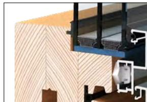
Die moderne Innenansicht des Fensters wird durch die geradlinige fugenlose Glasleistentechnik der Groß-Holz-Alu-Fenster perfektioniert.
