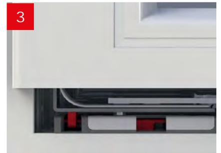
Das Fenster ist geschlossen und verriegelt. Der **8-Kant-Verschlussbolzen** hinterkrallt beim Verschließen das Sicherheitsschließblech und der **TRESOR-RIEGEL** verriegelt mit dem Fensterflügel. Ein Aushebelschutz von bis zu einer  $\frac{1}{2}$  Tonne gewährleistet höchste Sicherheit.
