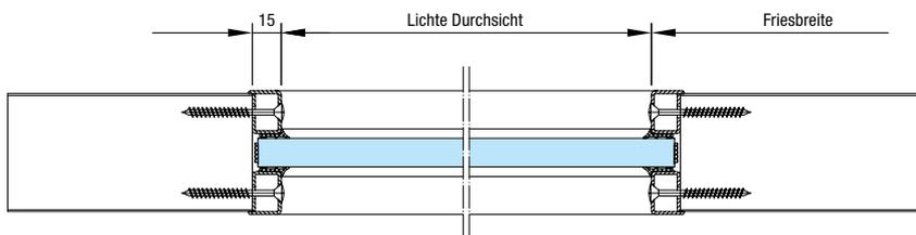
**Verglasung mit stumpfem Stahlprofil** für Rechteckverglasung (nur bei MZ- und El<sub>2</sub>30-Türen möglich)
