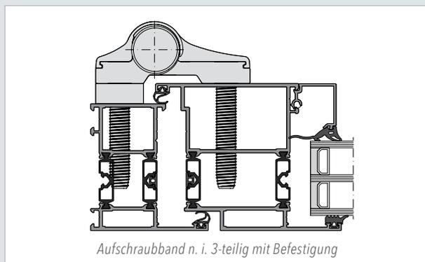
Aufschraubband n. i. 3-teilig mit Befestigung
