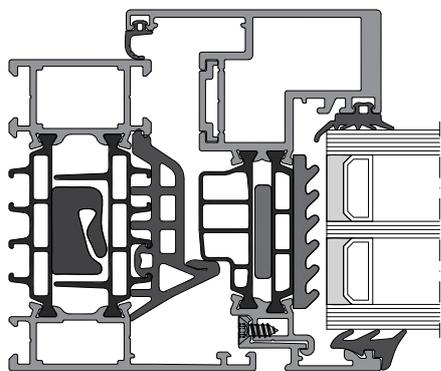
FRAME<sup>+</sup> 75 SF Blendrahmen mit Flügel und 3-fach Verglasung
